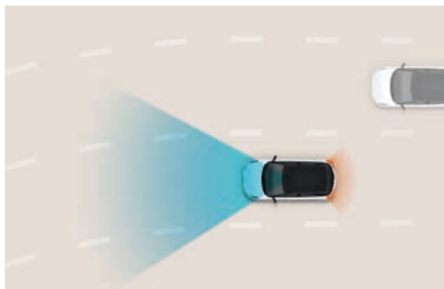
Control de cruceo inteligente basado en navegación (NSCC). Utiliza el sistema de navegación de última generación para anticiparse a las curvas y rectas de la autopista y ajusta automáticamente la velocidad para una conducción más segura. Asimismo, si está activado, la velocidad se ajusta automáticamente cada vez que cambian los límites de velocidad señalizados en la carretera.
